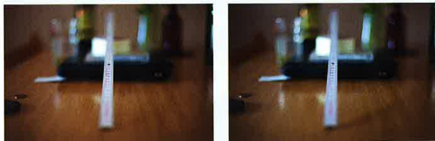
Ett sätt att kalibrera autofokusen är att lägga en linjal i 45 graders lutning och fokusera på en punkt. Då ser du tydligt om objektivet lider av fram- eller bakfokus.
