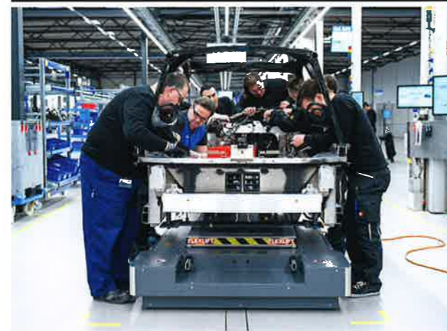
I den nybyggda fabriken "Werk 1" med solpaneler på taket och en digital produktionslina enligt industri 4.0, skruvas den lilla bilen ihop på endast 28 stationer. Hela konstruktionen skiljer sig från hur konventionella bilar byggs.
